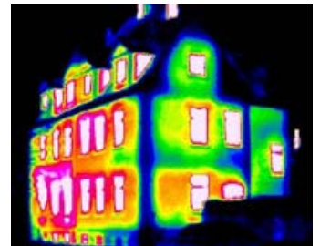
Mit Wärmebildaufnahmen wird die Wärmedämmung der Gebäudehülle überprüft.
